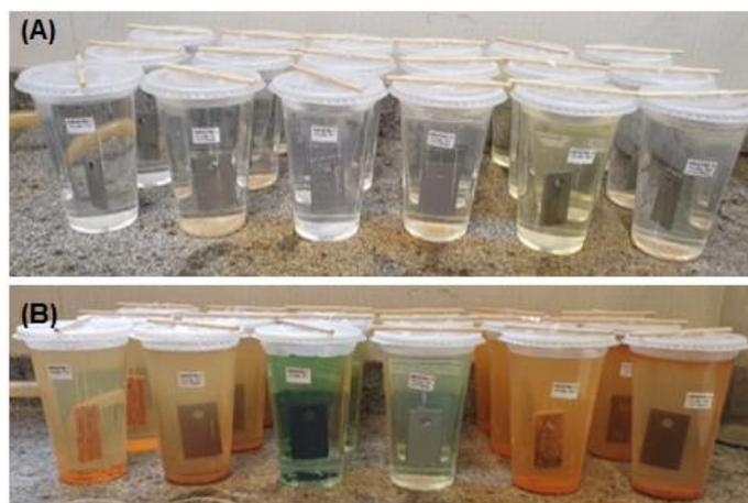
Figura 5 - Ensaio de corrosão: (A) início do ensaio; (B) após 21 dias de ensaio. Fonte: dados da pesquisa
