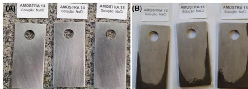
Figura 21 - Corpo de prova utilizado no ensaio em solução de NaCl sem inibidor: (A) antes do ensaio; (B) após 21 dias de ensaio. Fonte: dados da pesquisa
