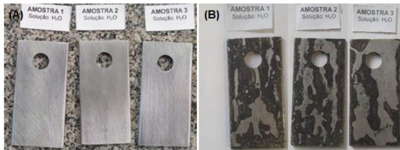
Figura 12 - Corpo de prova utilizado no ensaio em solução de H<sub>2</sub>O sem inibidor: (A) antes do ensaio; (B) após 21 dias de ensaio. Fonte: dados da pesquisa
