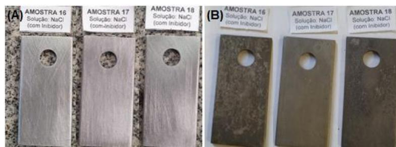
Figura 22 - Corpo de prova utilizado no ensaio em solução de NaCl com inibidor: (A) antes do ensaio; (B) após 21 dias de ensaio. Fonte: dados da pesquisa
