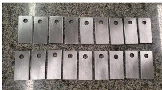
Figura 4 - Corpos de prova em aço carbono AISI/SAE 1020. Fonte: dados da pesquisa
