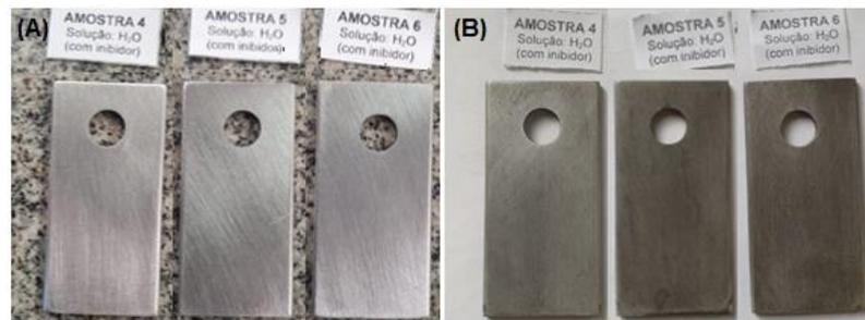
Figura 13 - Corpo de prova utilizado no ensaio em solução de H<sub>2</sub>O com inibidor: (A) antes do ensaio; (B) após 21 dias de ensaio. Fonte: dados da pesquisa
